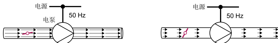
图 8-79 50 Hz 电源上使用泵和节流阀的流体控制
